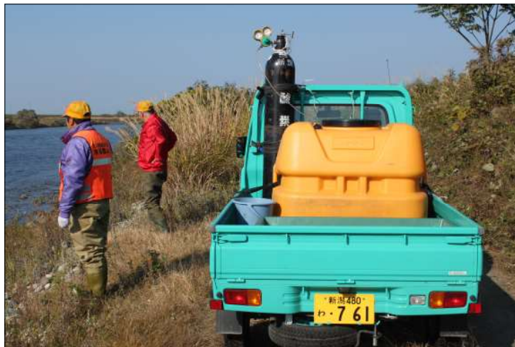
Рис. 3. Мини-грузовик с аэрируемым баком для перевозки самок кеты от реки до лососевого завода Аракава Fig. 3. Mini truck with aerated tank for transport of chum salmon females from river to Arakawa salmon hatchery
