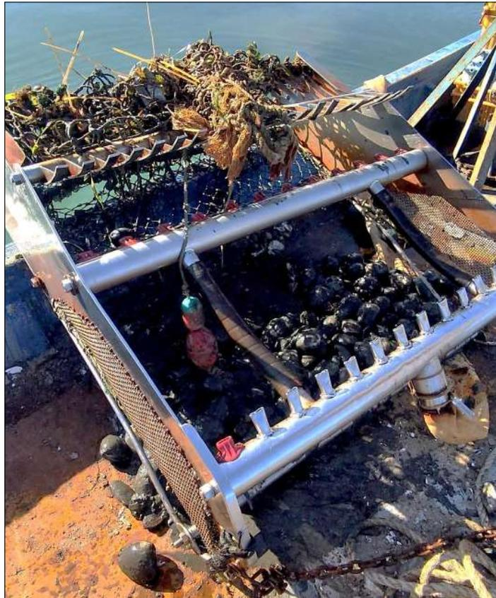
**Рис. 1.** Механическая драга с гидромонитором, использованная в ходе работ по изучению инфаунальных видов в северо-западной части залива Анива в августе–октябре 2022 г.
