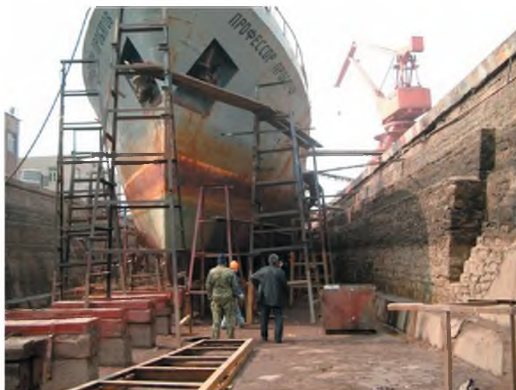
НИС «Профессор Прубатов» поднят в сухой док в порту Далянь для ремонта
