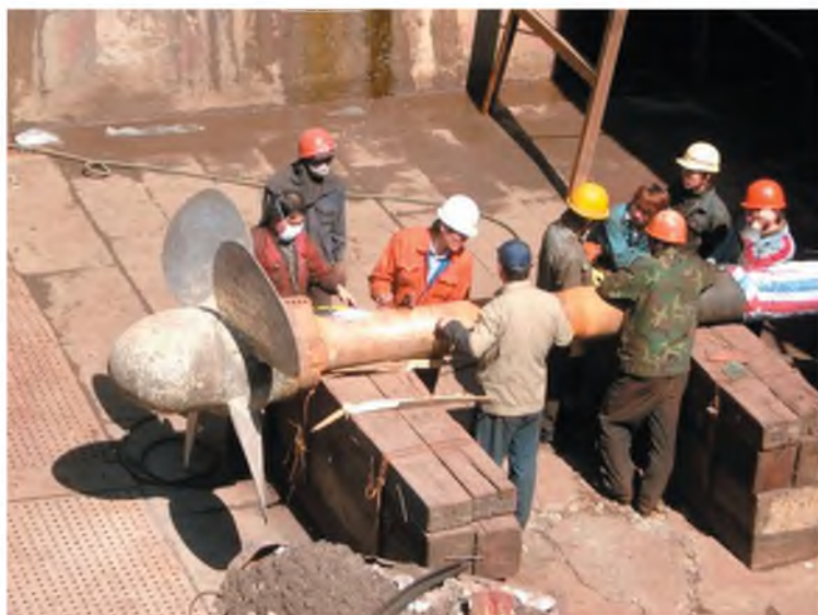
Китайские судоремонтники исследуют извлечённый гребной вал СРТМ. В оранжевом комбинезоне, по-видимому, инженер
